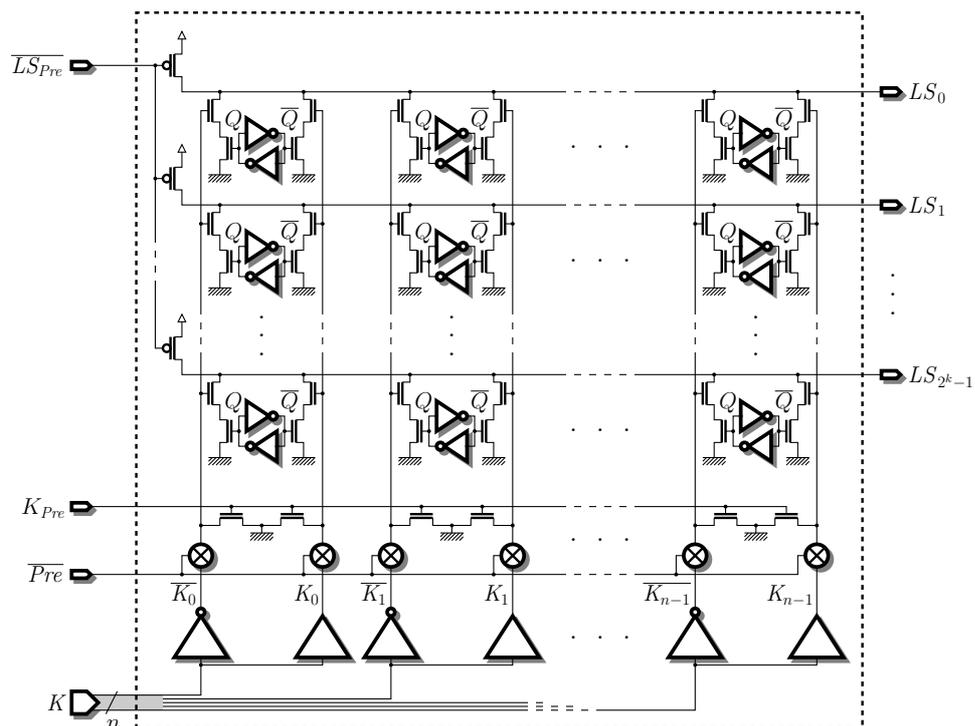
Notez ici que la précharge à 1 des lignes  $LS_i$  demande de déconnecter d'abord ces lignes des éléments de mémorisation, ce qui se fait en préchargeant les fils  $K_j$  et  $\overline{K_j}$  à 0, grâce au signal  $K_{Pre}$ . Cette précharge requiert à son tour l'isolation des fils  $K_j$  et  $\overline{K_j}$ , grâce à des portes trois-états contrôlées par le signal  $\overline{Pre}$ .
