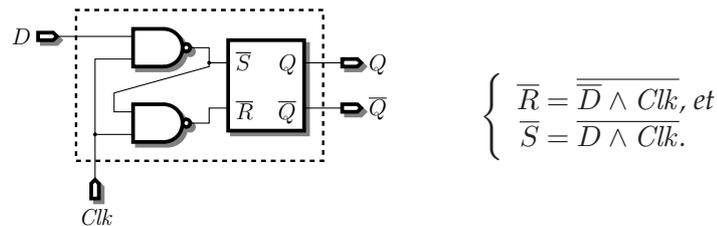
La bascule D se schématise de la manière suivante (notez l'arc de cercle symbolisant le fil d'horloge, avec transition sur état) :
