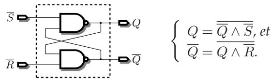
On schématise la bascule RS de la manière suivante :
