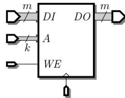
Elle repose sur une grille de  $2^k$  lignes de  $m$  registres  $D$  munis d'un clock enable. Chacun des  $m$  bits de  $DI$  est distribué aux  $2^k$  registres correspondants, le choix du registre dans lequel la donnée sera écrite étant réalisé grâce aux  $CE$ .
