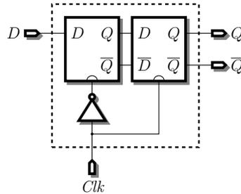
Il est schématisé par le symbole suivant (notez l'angle sur le fil d'horloge, qui dénote la sensibilité sur front) :
