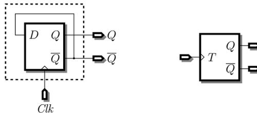
Il suffit alors de mettre plusieurs registres  $T$  en série, la sortie  $\bar{Q}$  de l'un étant connectée à l'horloge de la suivant. On obtient ainsi un compteur binaire, comme représenté ci-dessous pour 4 bits (les poids faibles sont à gauche) :
