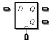
5. Réutilisez la bascule D pour définir un registre sur front (aussi appelé *D flip-flop*) : une structure à deux entrées ( $D$  et  $Clk$ ) et deux sorties ( $Q$  et  $\bar{Q}$ ) qui recopie  $D$  sur  $Q$  lorsque  $Clk$  passe de 0 à 1 (front montant), et qui garde l'état courant le reste du temps.
